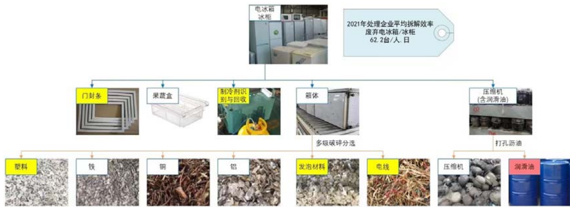
图4.4 电冰箱、冰柜工艺流程及平均拆解效率
