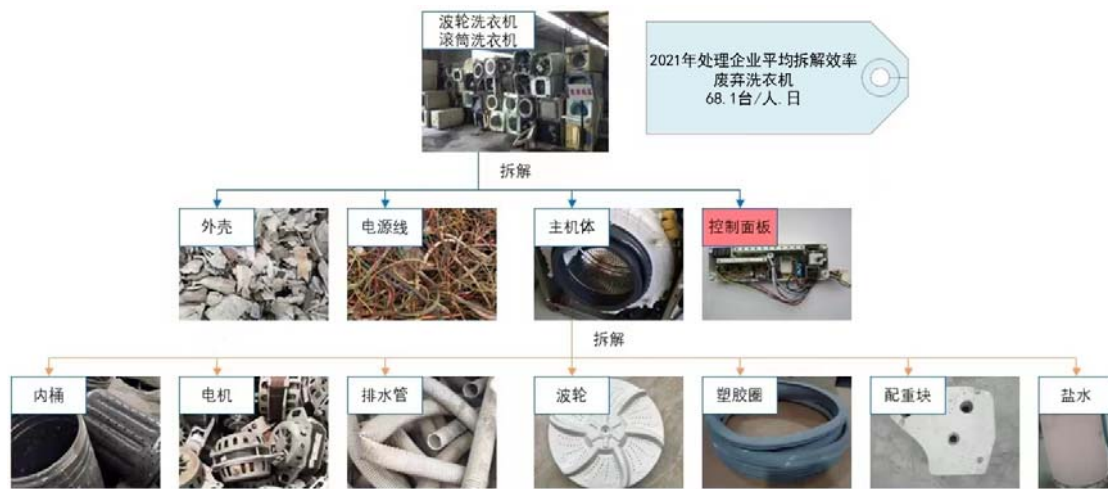
图4.5 洗衣机处理工艺流程及平均拆解效率
